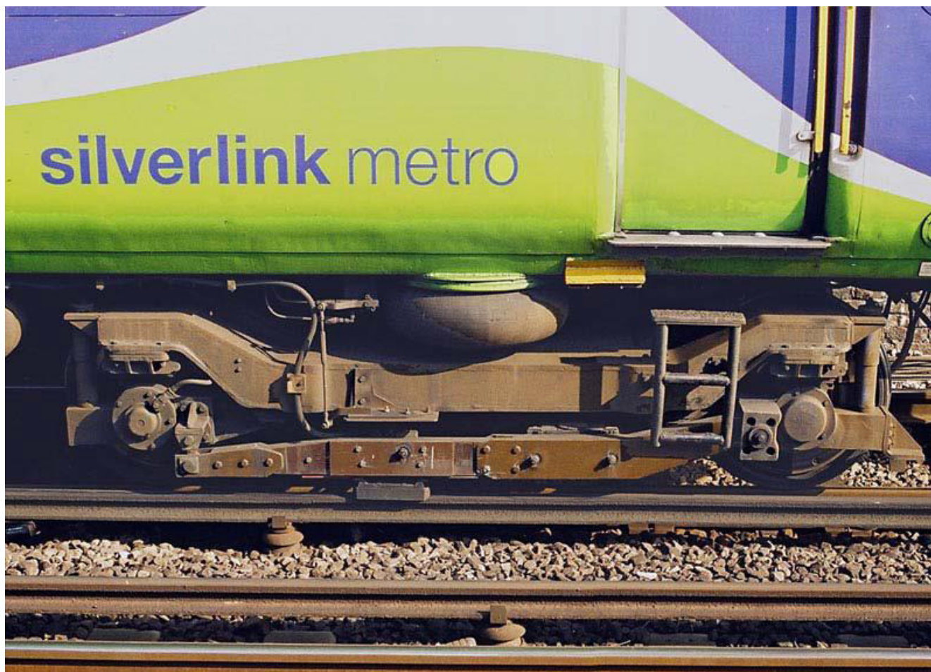
با تماس سطحی سیستم های ریل سوم و چهارم، یک کفشک سنگین با یک بازوی چوبی متصل به بوژی، توان را از طریق لغزش بر روی سطح ریل الکتریکی دریافت می کند. این نما یک قطار ریل بریتانیایی کلاس ۳۱۳ را نمایش می دهد.
