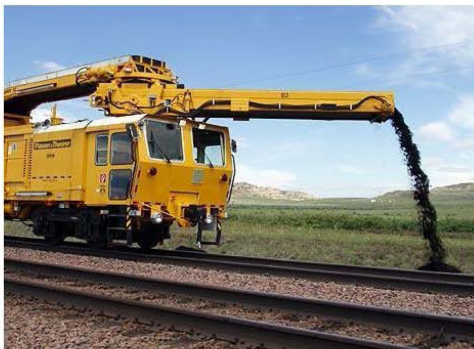
شکل ۴-۱- تصویری از دستگاه سرد در حال سرد نالاست
