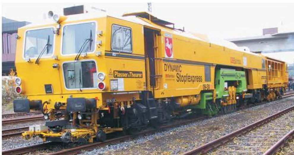
شکل ۲-۶- ماشین زیرکوب، از نوع عملیات پیوسته
