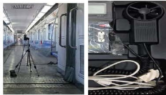
شکل ۱۵: ب‌دستچ بکر رفته جهت اندازه‌گیری سرعت جریان هوا و محل انجام اندازه‌گیری‌ها داخل قطار
